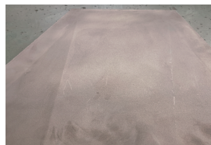
图6 物理试验蒙皮表面未产生沟槽 Fig.6 No groove on actual test panel surface
